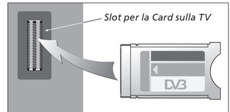
Il modulo deve essere inserito in modo che i bordi inferiore e superiore – aventi forma diversa – corrispondano alle scanalature dello slot.
